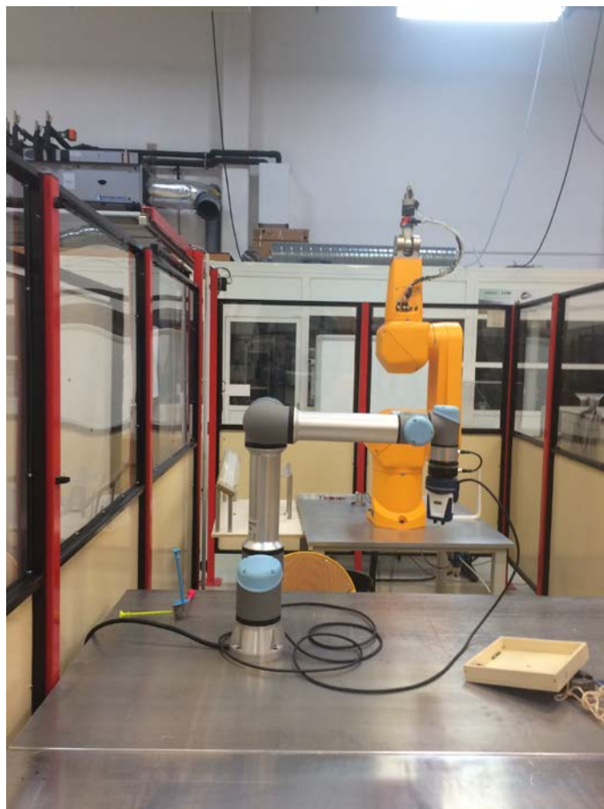
Figure 2 : Poste robotisé – robot anthropomorphe e-UR 5
