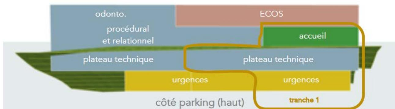
Ce bâtiment sera conçu dès l'origine pour accueillir, à terme, les tranches 2 et 3 (présentées en III.6.1). La conception du bâtiment anticipera les surélévations ultérieures dans le dimensionnement de la structure et des fondations du bâtiment, ainsi que dans celui des installations techniques
